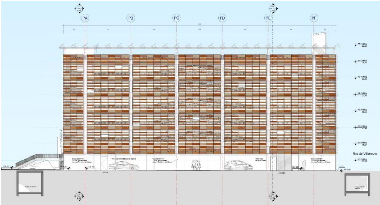
Figure 17 : façade est avec brise-soleil en terre cuite.
